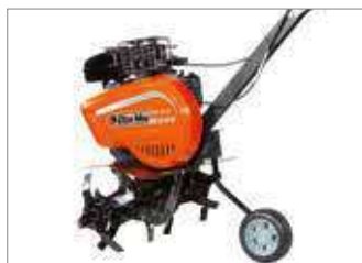
Rueda trasera para transportar la máquina.
